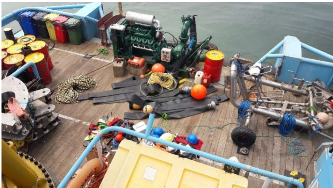
Figure 38 : Ensouillage par jetting avec outil tracté de type « Jet sledge » sur navire petit fond (Source : Orange Marine)
