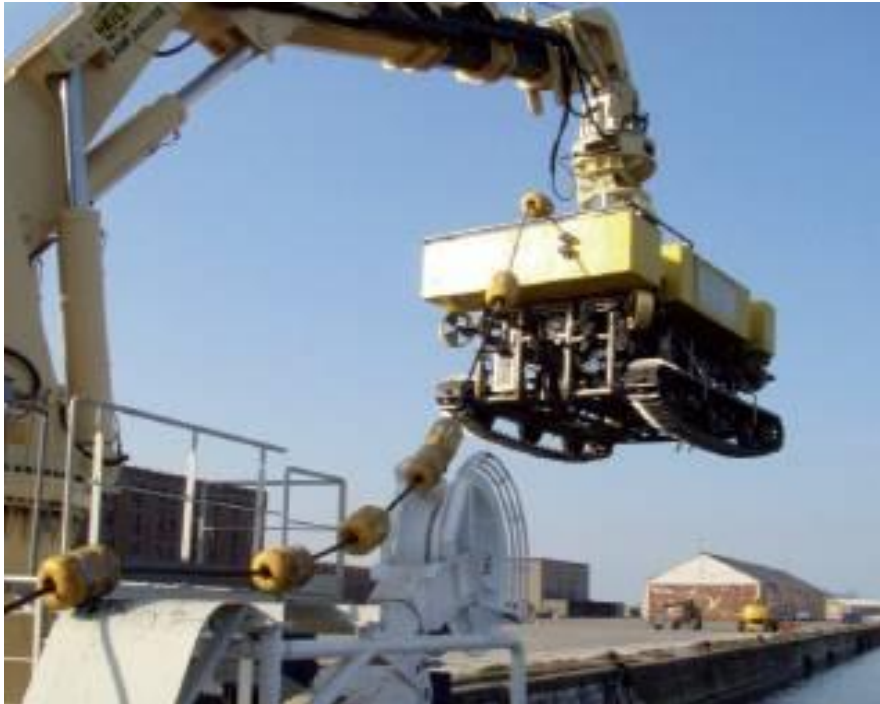
Figure 44 : ROV pouvant assurer l'ultime étape de vérification du bon ensouillage du câble (Source : ASN)
