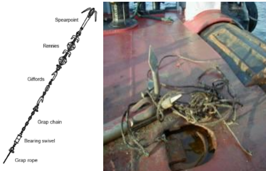
Figure 33 : Grappin utilisé lors du PLGR (à gauche) et type de débris remontés sur le navire après le PLGR (à droite)
