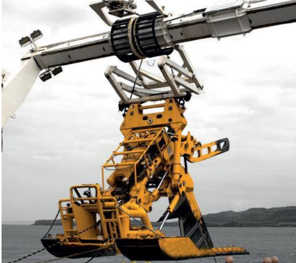
Figure 42 : Exemple de charrue tractée (Source : Orange Marine)
